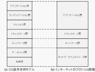
(a) OSI基本参照モデル (b) インターネットのプロトコル階層
